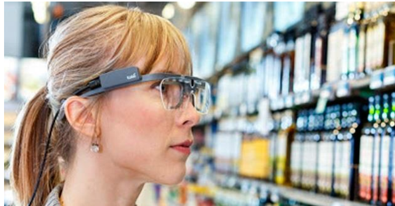
Figura 2.- Sistema eye tracking basado en lentes con cámara
