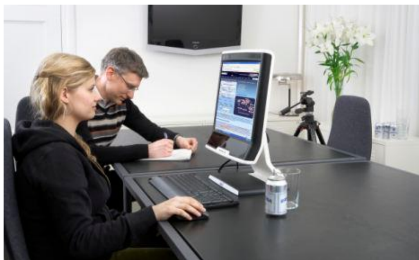
Figura 3.- Sistema eye tracking basado en monitor
