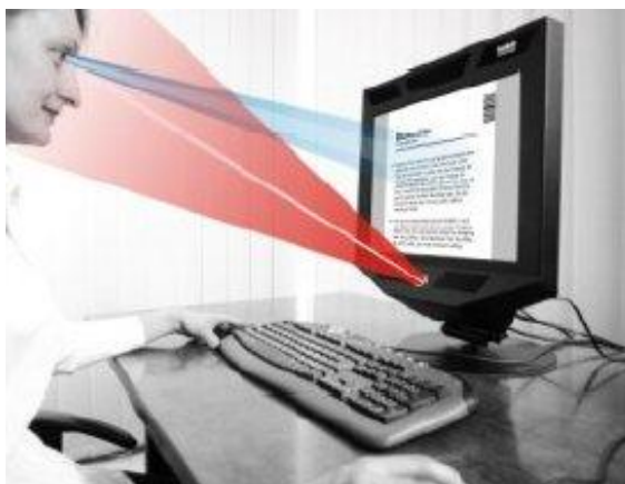
Figura 1.- Captura de movimiento ocular con luz infrarroja
